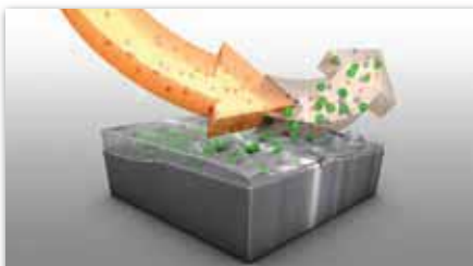
Grube ispune potkopane finim česticama
